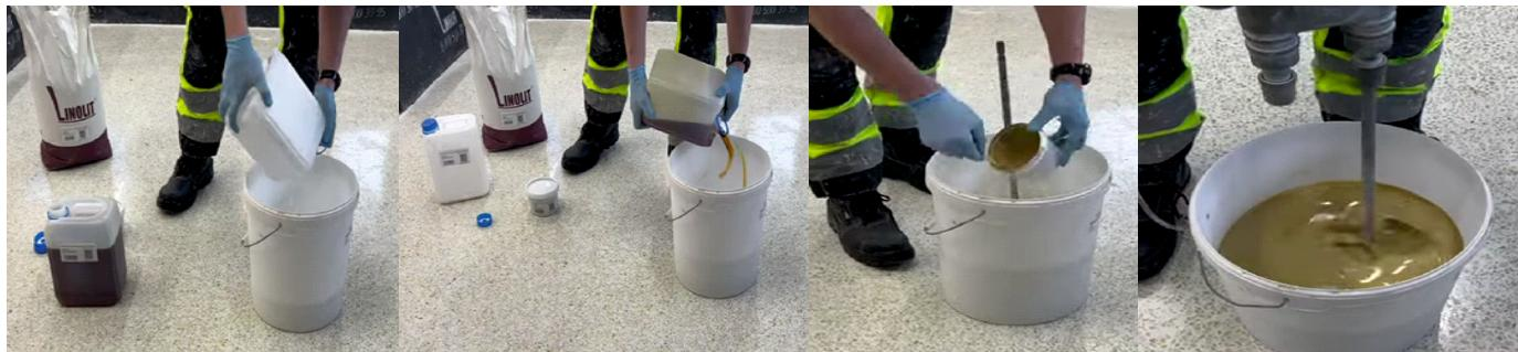
2. Постепенно вносить наполнитель (компонент С) в смесь компонентов, мешать в течение минимум 2 минут до полного перемешивания и получения гомогенной (однородной) смеси. Рекомендуемое время смешивания: 2-3 минут.
